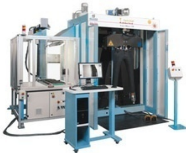
Slika 11: Laser za iscrtavanje šara na odevnim predmetima "BRUSH ROBOT E5"
