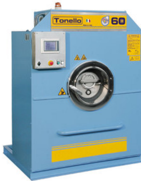
Slika 14: Mašina za obradu uzoraka odeće pranjem, bojenjem ili kamenovanjem
