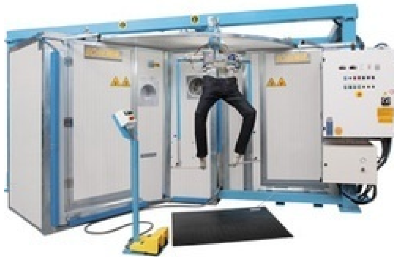
Slika 10: Sistem za kreiranje 3D efekata na jeans-u "LASER BLAZE TM, T, M, S"
