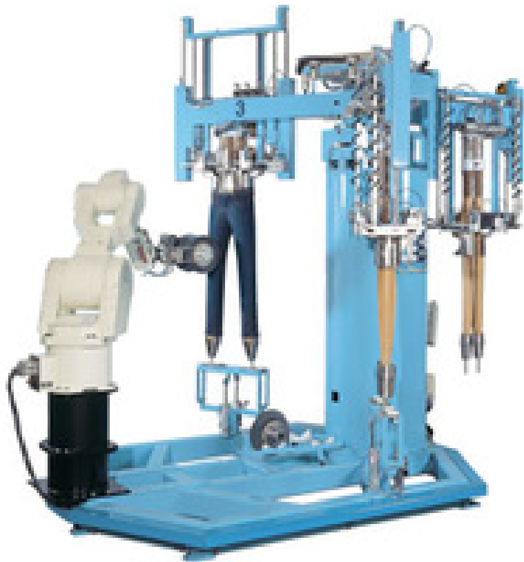
Slika 12: Robot za automatsko brušenje jeans-a „SCRATCH O, V, V3, 3D“
