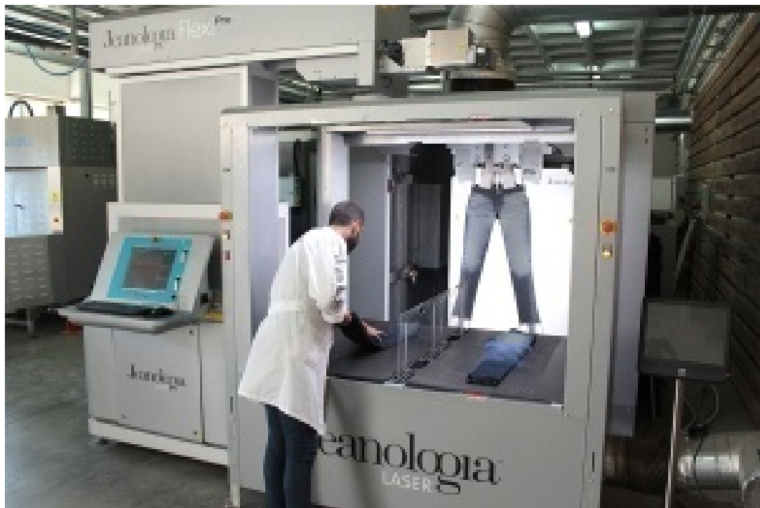
Slika 8: Savremeni sistem za lasersko efektiranje džinsa
